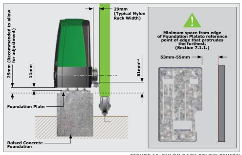
FIGURE 16. NYLON RACK BELOW PINION
