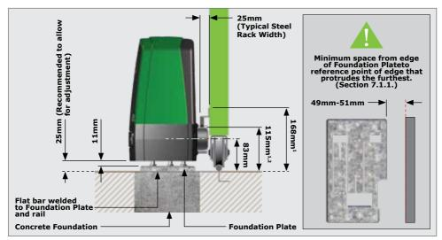
FIGURE 11. STEEL RACK ABOVE PINION
