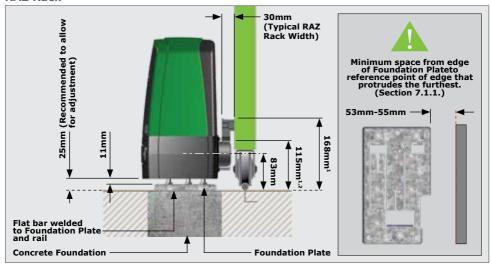
**FIGURE 13. RAZ RACK ABOVE PINION**
