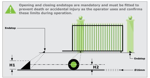
**FIGURE 4. FITTING ENDSTOPS**
