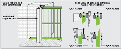
FIGURE 5. FITTING GUIDE-ROLLERS
