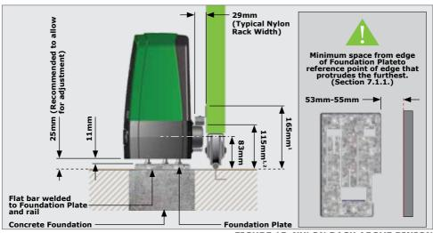
**FIGURE 15. NYLON RACK ABOVE PINION**
